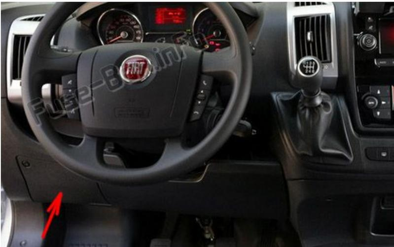
Pour accéder aux fusibles dans la boîte à fusibles sur le tableau de bord, desserrez les vis de fixation A et retirez le couvercle.
